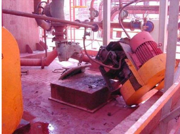
Temos que reconhecer que inicialmente soa bem estranho a frase "a bomba de água explodiu". No entanto, explosões de bombas centrífugas não são raras e decorrem principalmente da falha operacional em colocar a bomba em operação com as válvulas de sucção e recalque fechadas, sem que haja um sistema de alívio de pressão ou uma linha de reciclo no trecho de enclausuramento do líquido.
